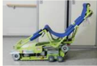
非常用階段昇降機
