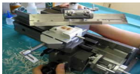
ミクロトームという切片を作る専用器具
